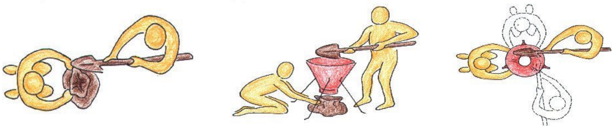
Metodo tradizionale per il riempimento dei sacchi con sabbia. Schema di utilizzo della tramoggia
